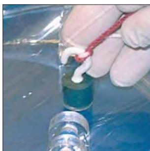
このフック（マグネット底面に**薄い**プラスチックリングが接着されているもの）は本体中心部に可動シリンダ（中・大）を用い使用します。
