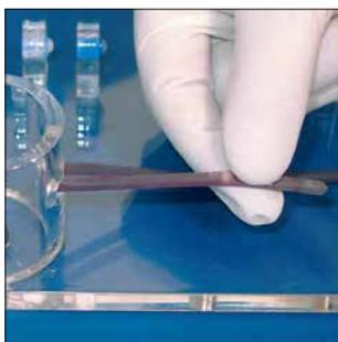
本体に固定されたシリンダの穴の片方に、糸結び用チューブを通します。
