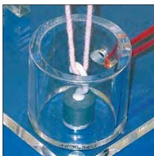
このフック（マグネット底面にプラスチックリングのないもの）は、本体に固定されたシリンダ小で使用します。
