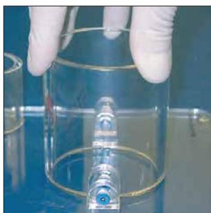
シリンダの端部には小さなくぼみがあります。このくぼみの片側を、まず本体に固定された青白の保持具の間に挟み込みます。それからカチッと音がするまで反対側のくぼみに回し入れます。
